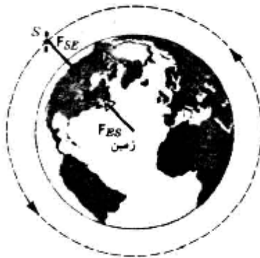
شکل (II). ماهواره ای در مدار زمین. نیروهایی که در شکل می بینید یک زوج عمل - عکس العملند. توجه کنید که این دو نیرو بر دو جسم مختلف اثر می کنند.
